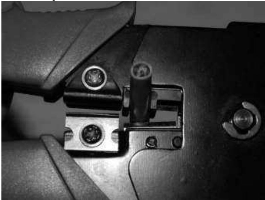
Рисунок 1.24 – Зачистки ізоляції виті пари
