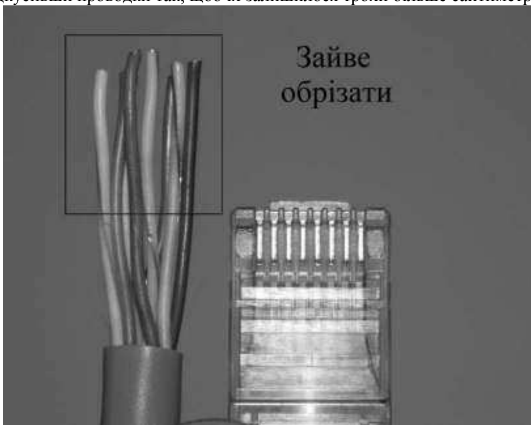
Рисунок 1.27 –Довжина обрізання проводів витії пари
