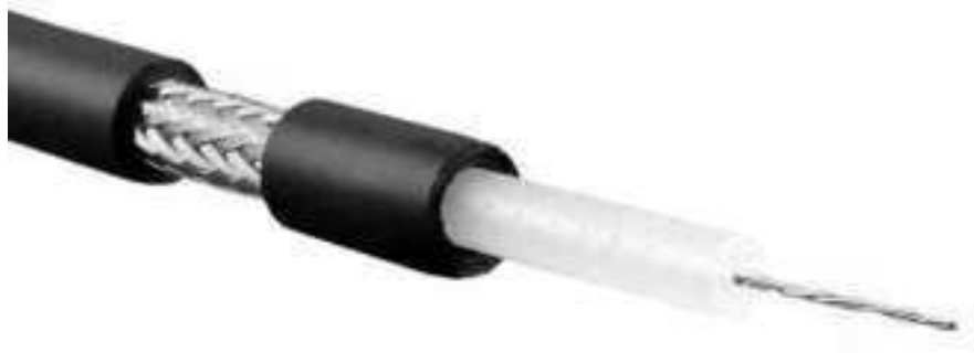
Рисунок 1.9 – Загальний вигляд широкосмугового коаксіального кабелю RG-59 (75 Ом): жила - 24 AWG(0.6 мм, мідь, багатожильний), зовн. діам. - 6.1 мм, екран (сітка 95%), легкий, гнучкий
