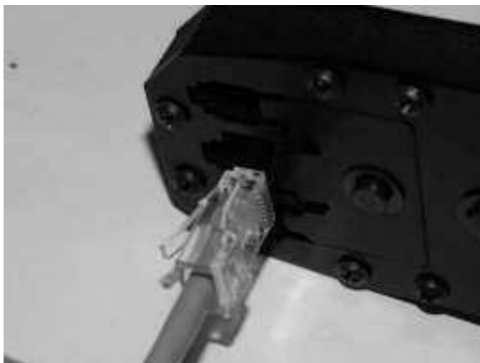
Рисунок 1.29 – Обтискання коннектора з встановленою парою
