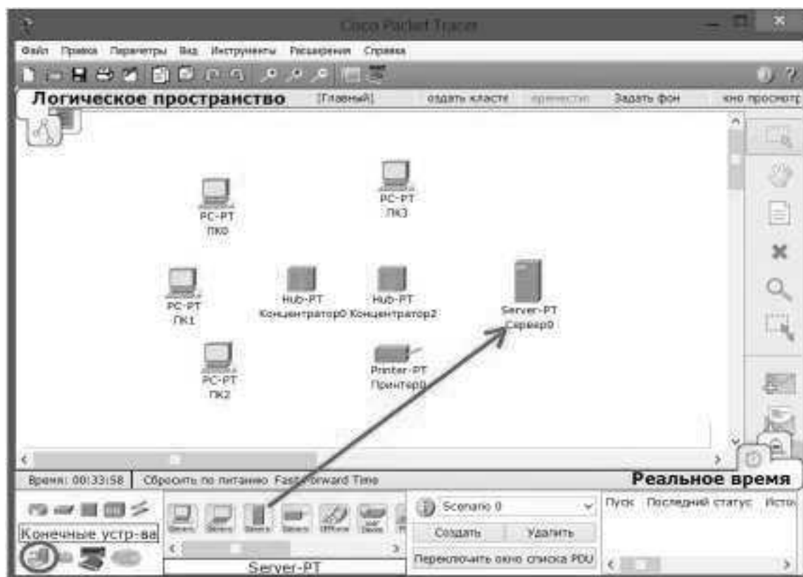
Рисунок 5.16 – Встановлення сервера на робочий простір
